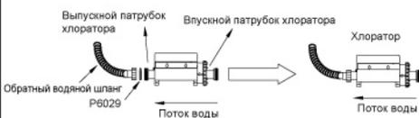
3. Подсоедините переходники шланга к впускному патрубку хлоратора и выпускному патрубку фильтрующего насоса или песочного фильтра, навинтив гайки переходников.
